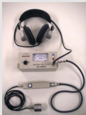
←日本製資器材の活用 (漏水発見器等)
