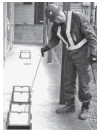
写真2 各戸音聴調査（音聴棒）
