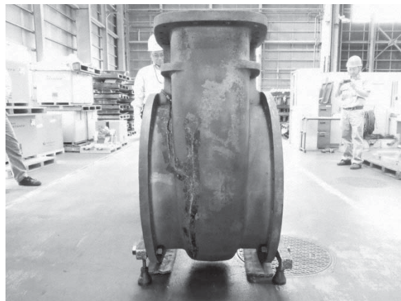
写真2 バルブの亀裂状況
