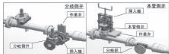
図2 分岐側弁等の着脱方法
