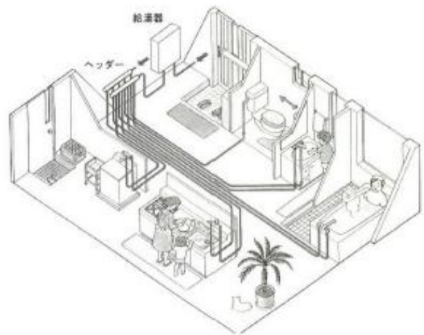
図 サヤ管ヘッダー配管の例
