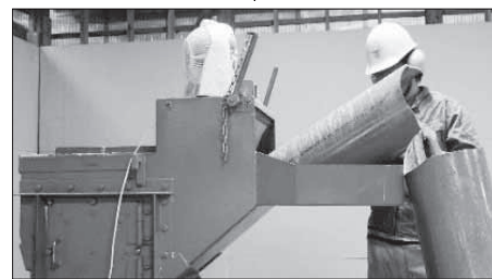
写真3 廃塩ビ管の粉碎処理
