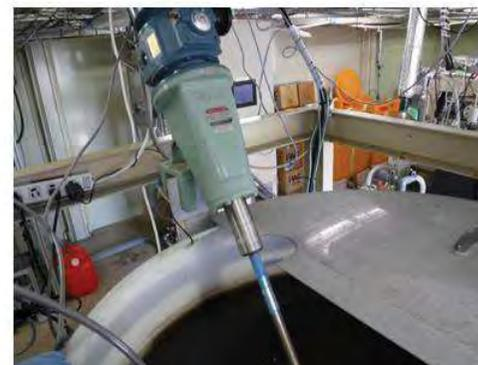
攪拌機で原水タンクを混合
