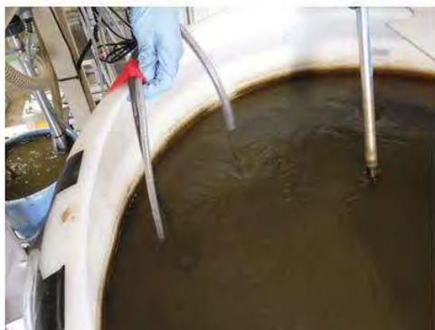
濃厚濁度液を原水濁度に滴下
