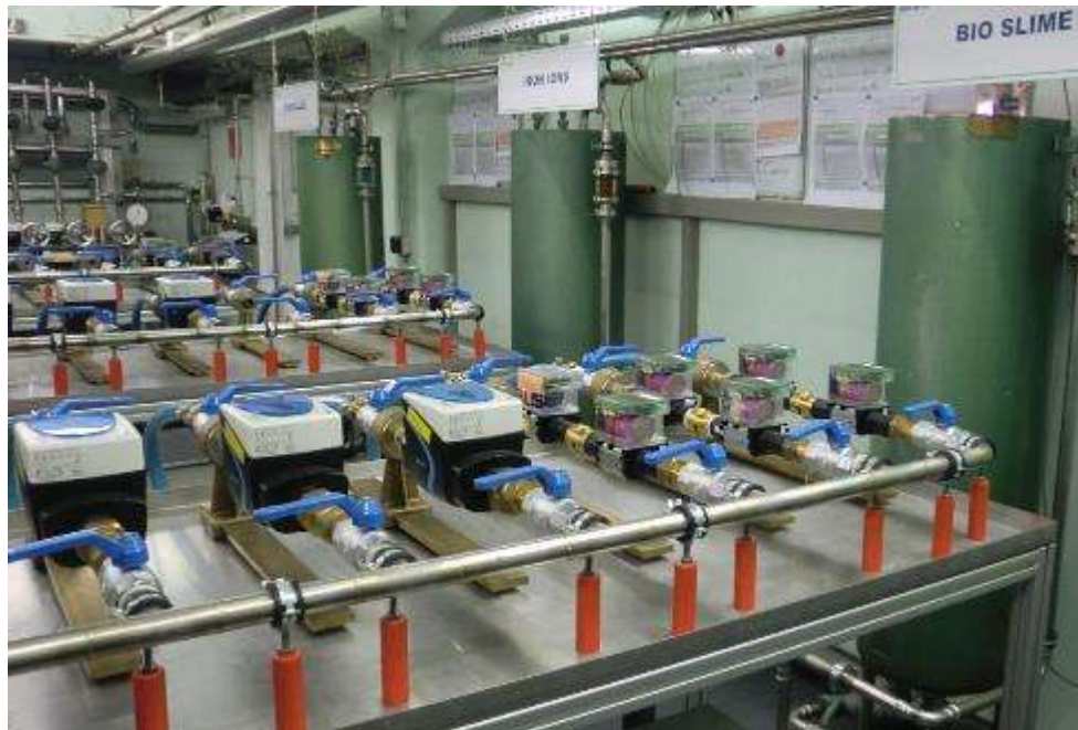
管内付着物による電気伝導率の低下影響
