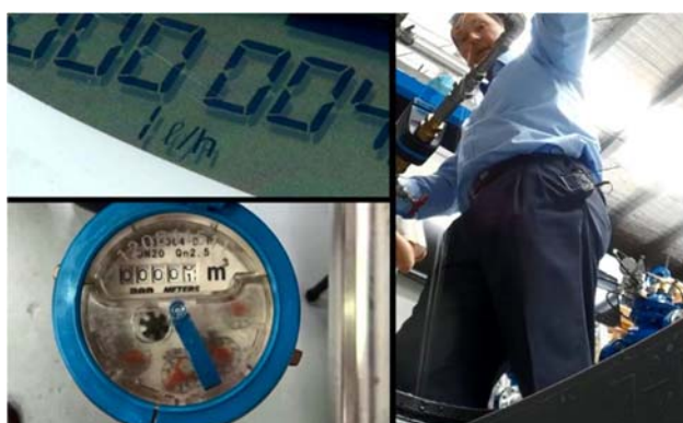
図17 視察した iPERL™の微量流量計測試験
