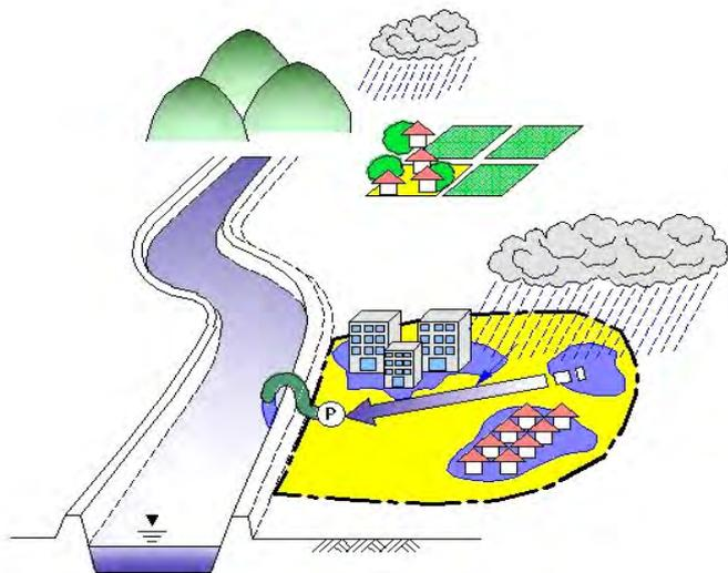
下水道の雨水排水能力を上回り浸水、または河川水位の上昇により、下水道から河川へ放流できず浸水
