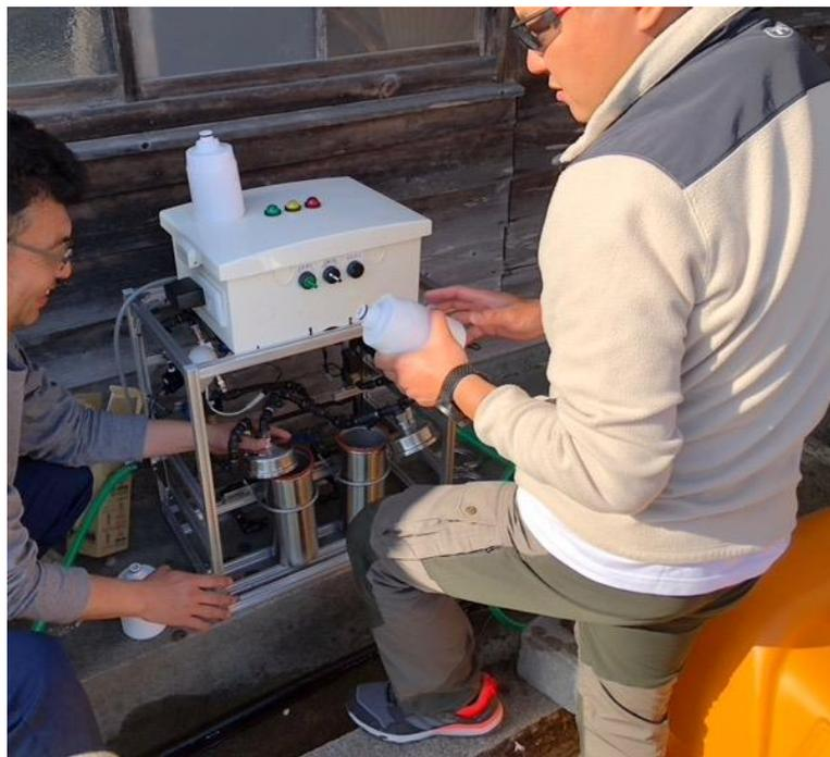
写真：モバイル浄水装置を用いた河川水の浄水試験の様子（講演者撮影）
