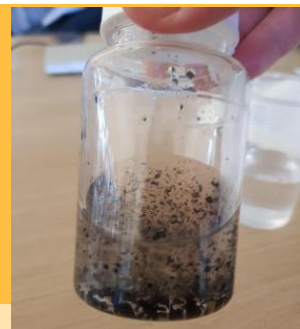
詰まりの原因となった剥落片 出典：環境保護庁（規制機関）
