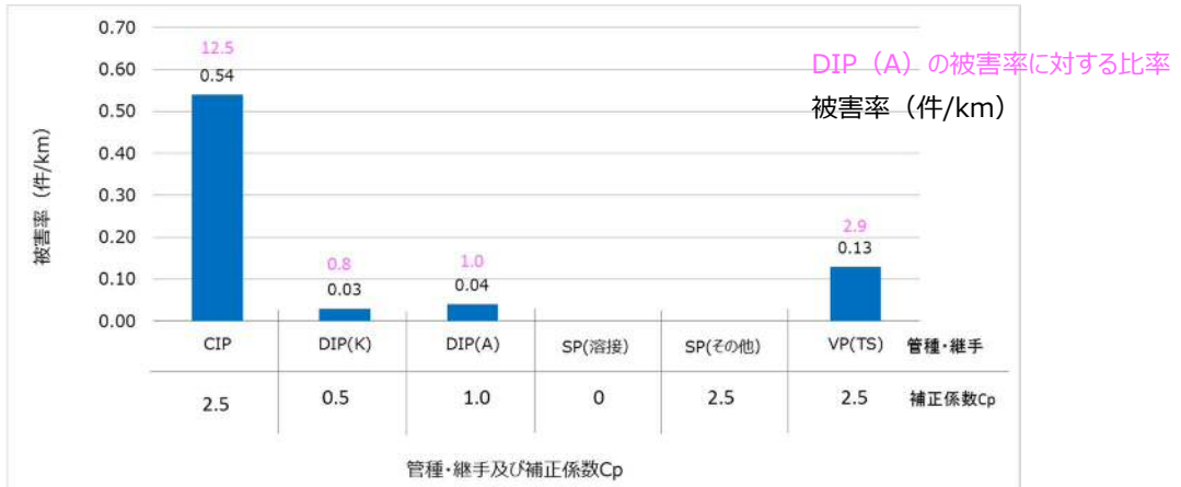
図 3-15 標準口径かつ標準微地形における管種別の被害率（熊本市）
