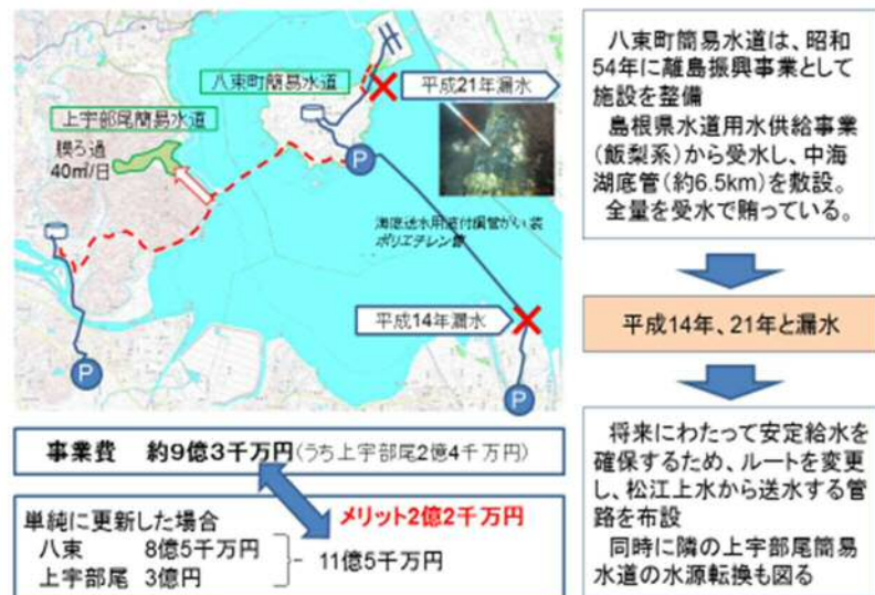
図 5. 旧簡易水道施設の整備事例
