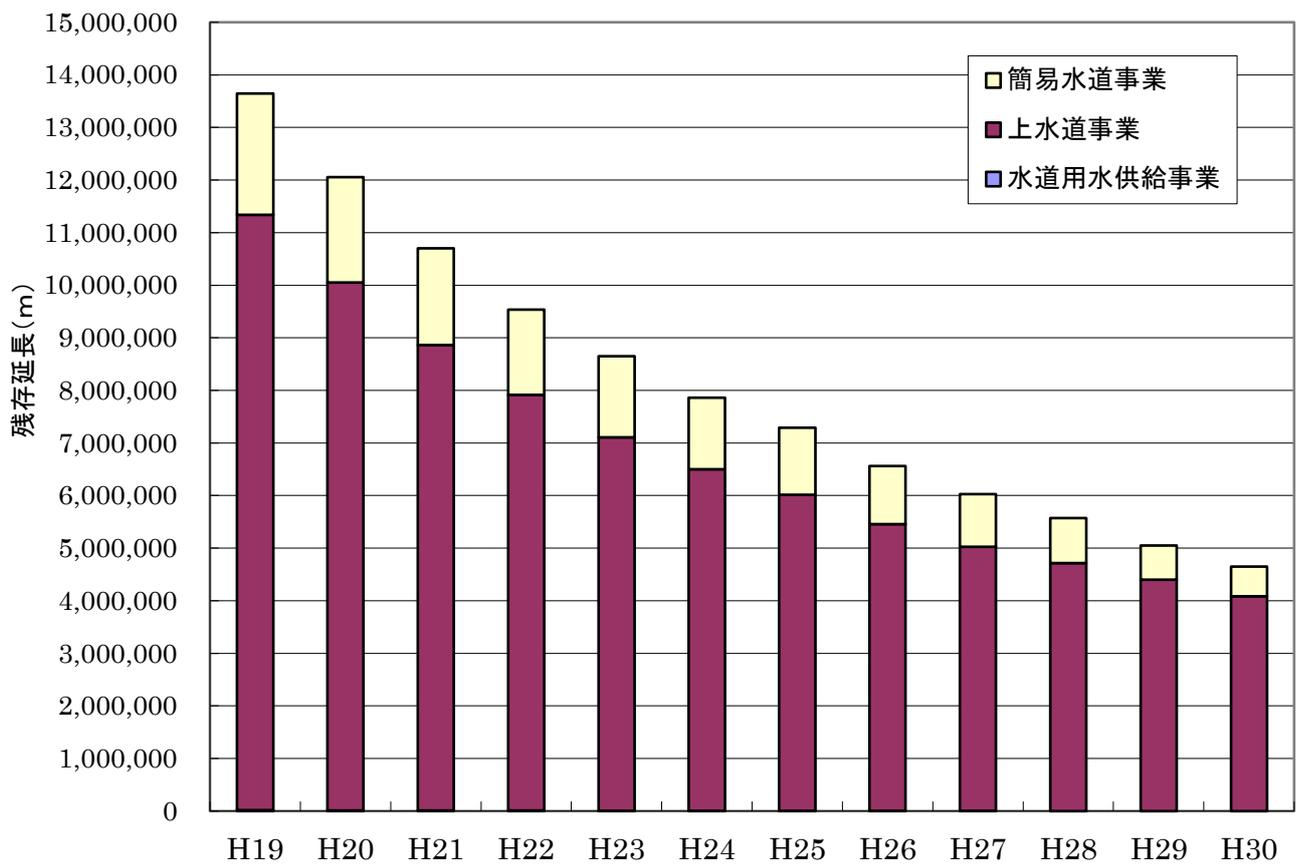
図1-1 石綿セメント管残存延長の推移(用供+上水+簡水)
