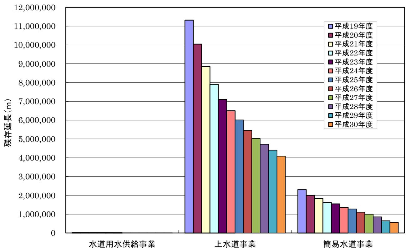
図1-2 石綿セメント管残存延長の推移(用供+上水+簡水)
