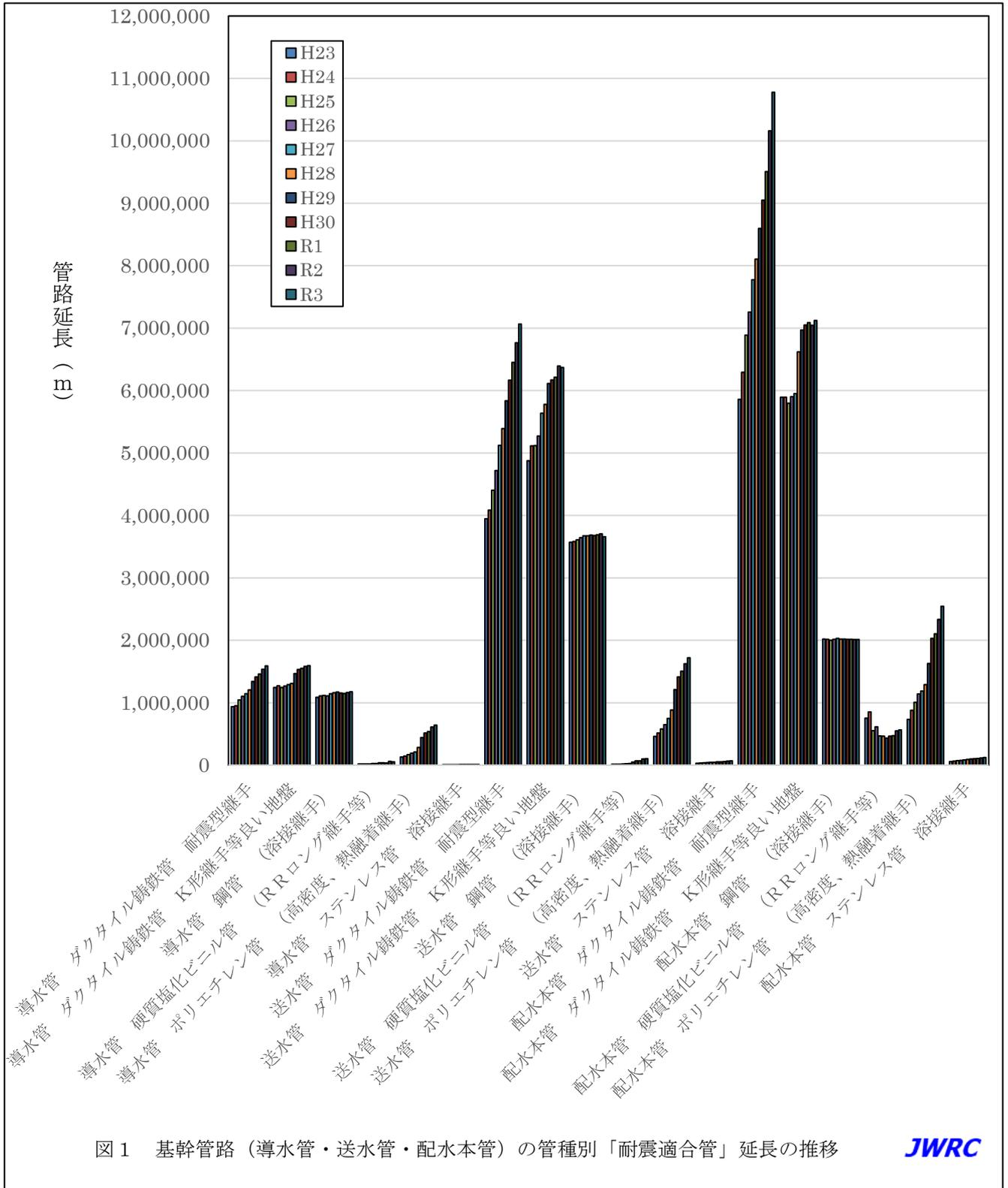
表1 基幹管路（導水管・送水管・配水本管）の管種別耐震適合管延長の推移
